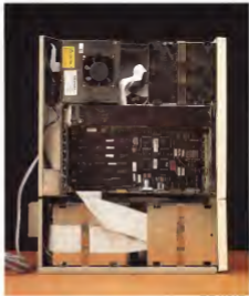
Visita generale sul computer aperto. Il lungo alloggiamento sopra la scheda madre contiene il scheda col pannello in basso gli alloggiamenti per i Winchester, ciascuna con il proprio alimentatore.
